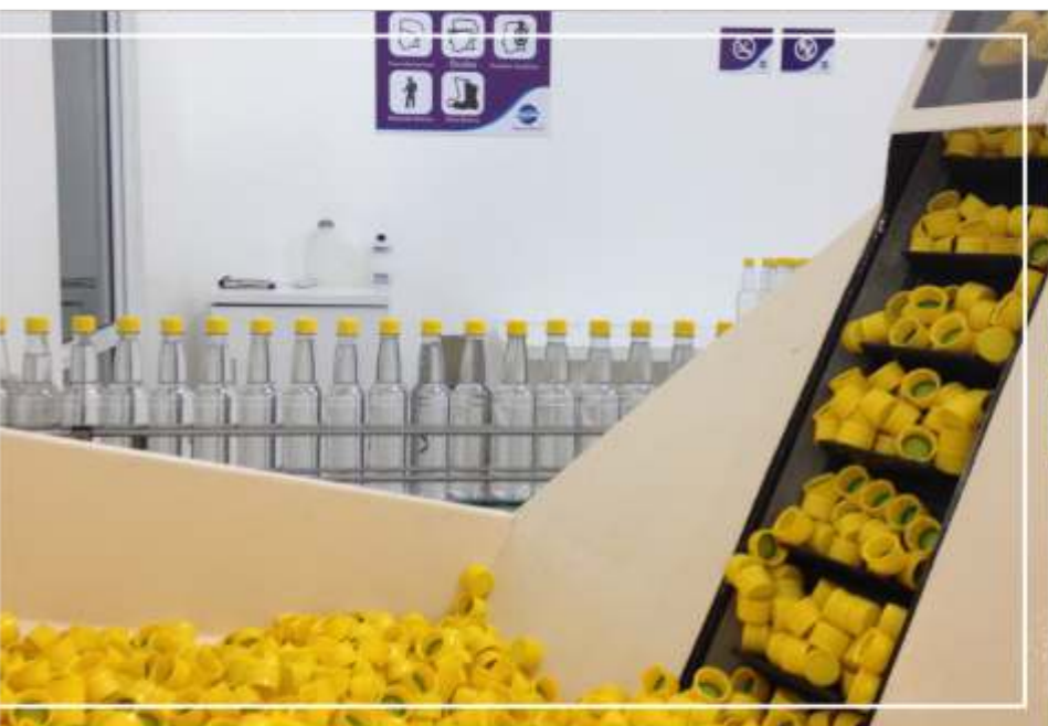
A linha de envase tem capacidade para encher 4 mil garrafas de 600 ml/hora e é enfiada em pacotes com 12 unidades
